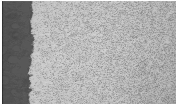
500X GRADE 1040 SPHEROIDIZED ANNEALED SIZE .340 HARDNESS RB = 76
